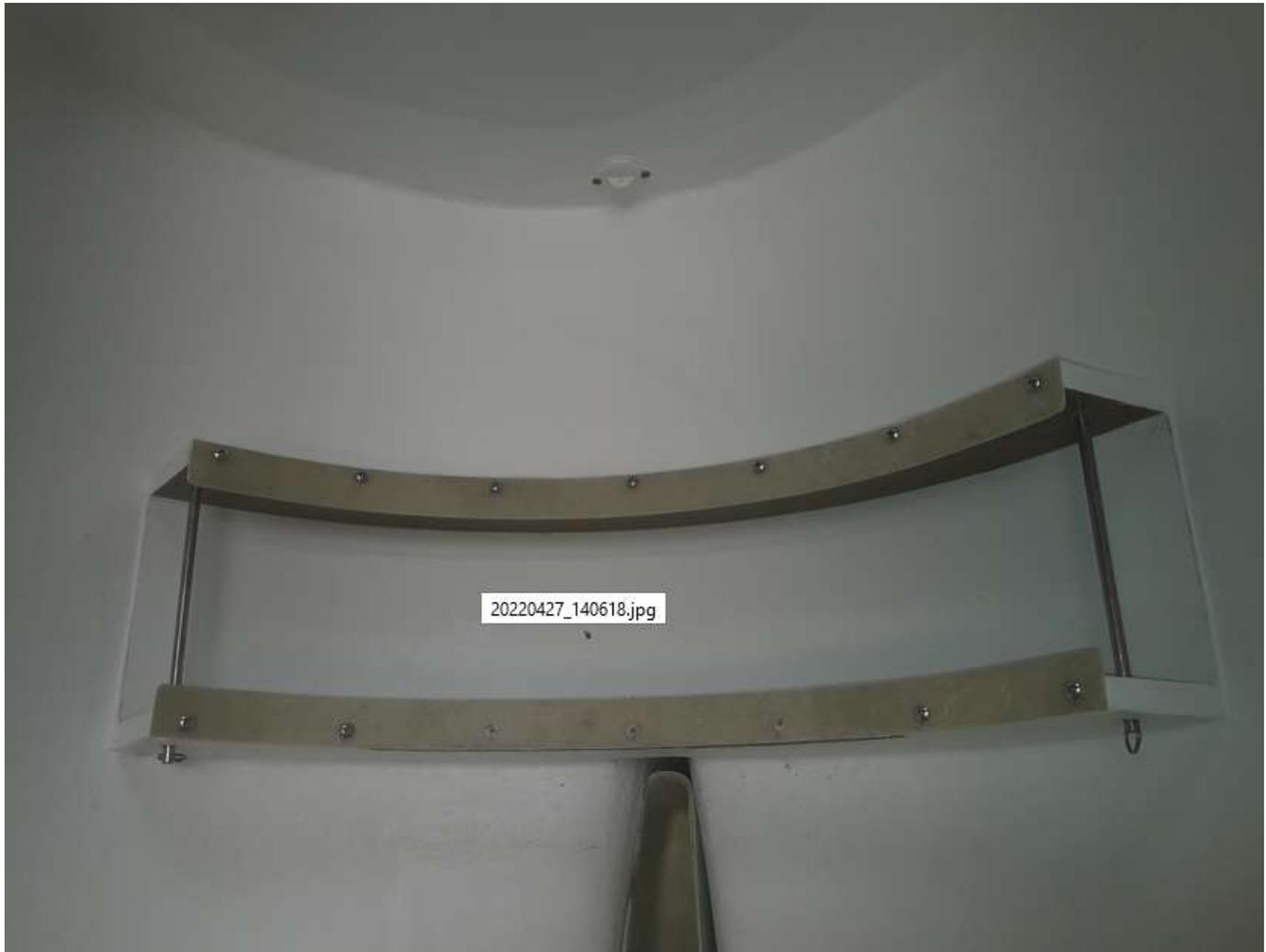
Structure du siège pour montage des roues sur le siège
