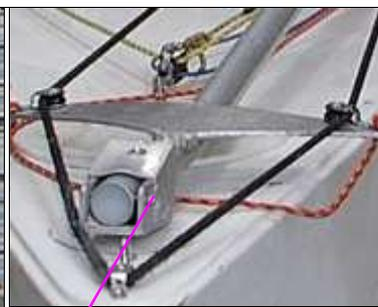
L'extrémité de la bôme est fixée par écrou et boulon dans une pièce en alu.
