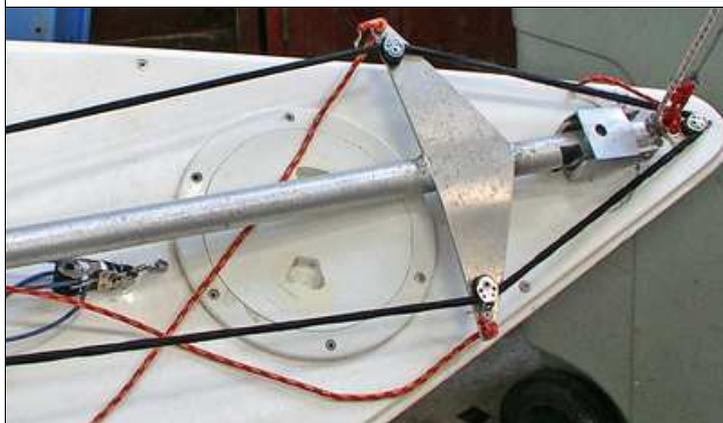
Un élastique (noir) est fixé sur le côté de la bôme sur un pontet, il passe ensuite dans une poulie à plat pont sur l'aile du rotateur, dans une poulie à plat pont à l'avant, puis dans une seconde poulie sur l'autre aile et finalement est tendu sur le second pontet.
